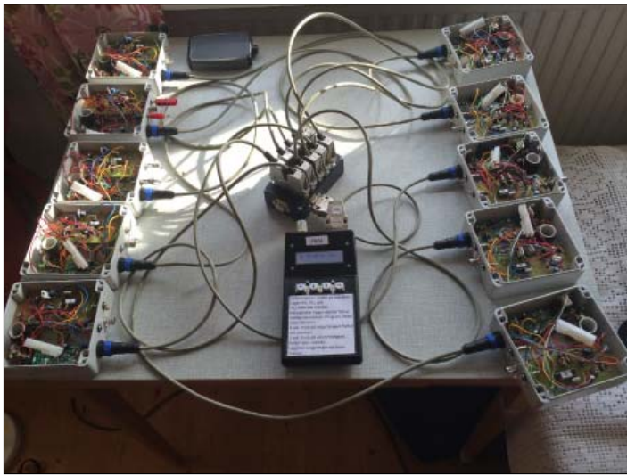
Bild 4, alla tio rävarna och PRALen sammankopplade inför programmering.
